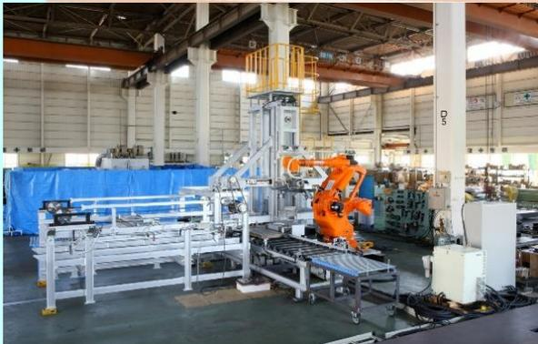
焼入れ工程において、加熱後製品を取出し、冷却工程へ搬送、完了後製品を次工程へ搬送する設備。
