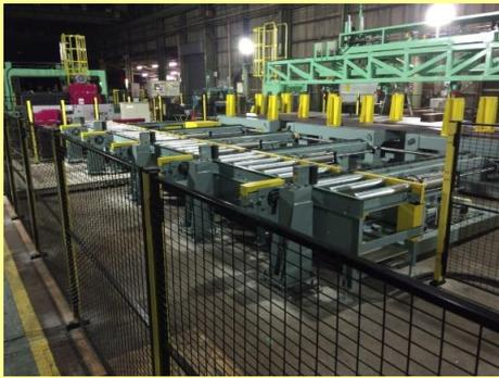
鋼材の切断工程における、素材のダンバシ～搬送～切断加工機への投入～精度検査～取出し後積み込みまでを一括自動化。
