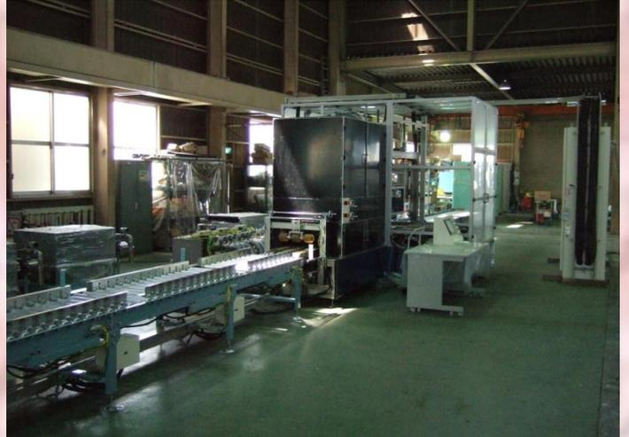
金属サイディングボードにインクジェットプリントを行う工程の搬送・位置決め装置です。インクジェットの着色に合わせてピッチ送りでボードを搬送していきます。
