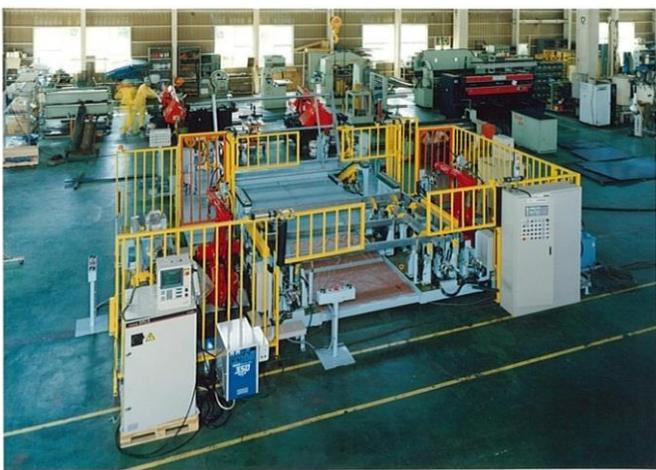
住宅用バルコニーの自動溶接装置です。大型ワークの治具クランプ、ロボット溶接に対応しています。
