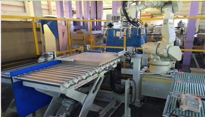
住宅木材部品メーカー向け搬送装置です。ミゾ加工前のパネル山をセットした後、1枚ずつ自動で切出し加工機へ投入します。製品バーコード入力で自動で品種段取りが可能です。
