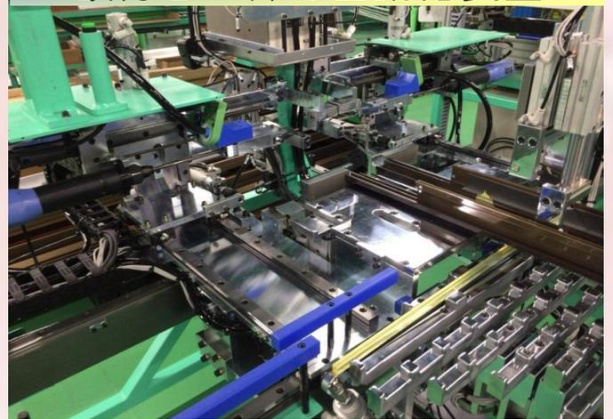
住宅用建材(額縁)のビス締め自動装置です。多品種生産に対応しています。
