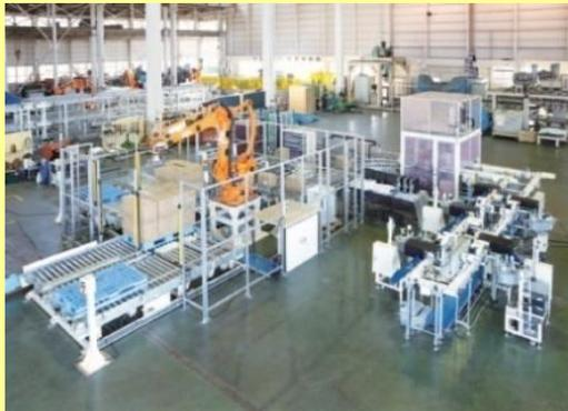
製品を向け先別に振り分ける為の設備です。向け先ごとに合わせてラベリング、及び画像処理で検査確認後梱包し出荷します。
