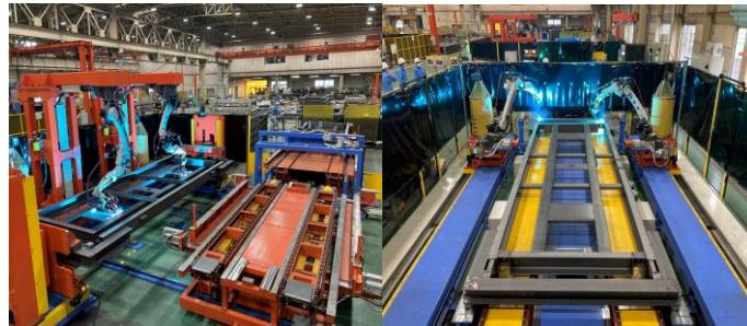
全長6M、約800kgのワークの搬送、位置決めを行い、左右・前後からロボットにて溶接を行う。裏側溶接の際に使用する反転機構もロボット制御で同期対応。
