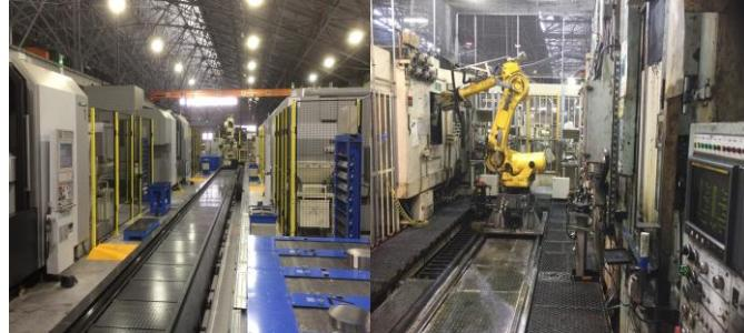
工作機械へのワーク投入・取出しを自動化し、段取りの省人化を行う。
