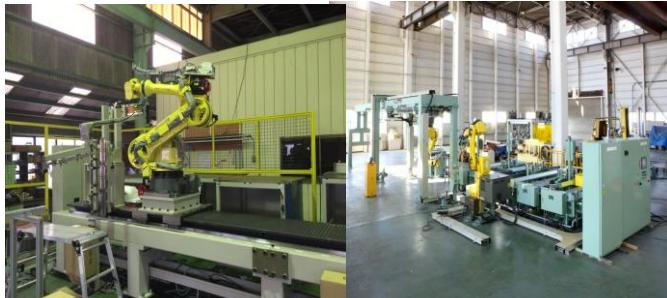
投入取出しとパレタイズの複合に加え、加工後のワーク清掃や型清掃、画像センサを用いた品種ポリューム機能も付属可能。
